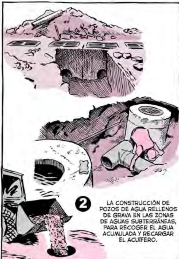
**2** LA CONSTRUCCIÓN DE POZOS DE AGUA RELLENOS DE GRAVA EN LAS ZONAS DE AGUAS SUBTERRÁNEAS, PARA RECOGER EL AGUA ACUMULADA Y RECARGAR EL ACUIFERO.
